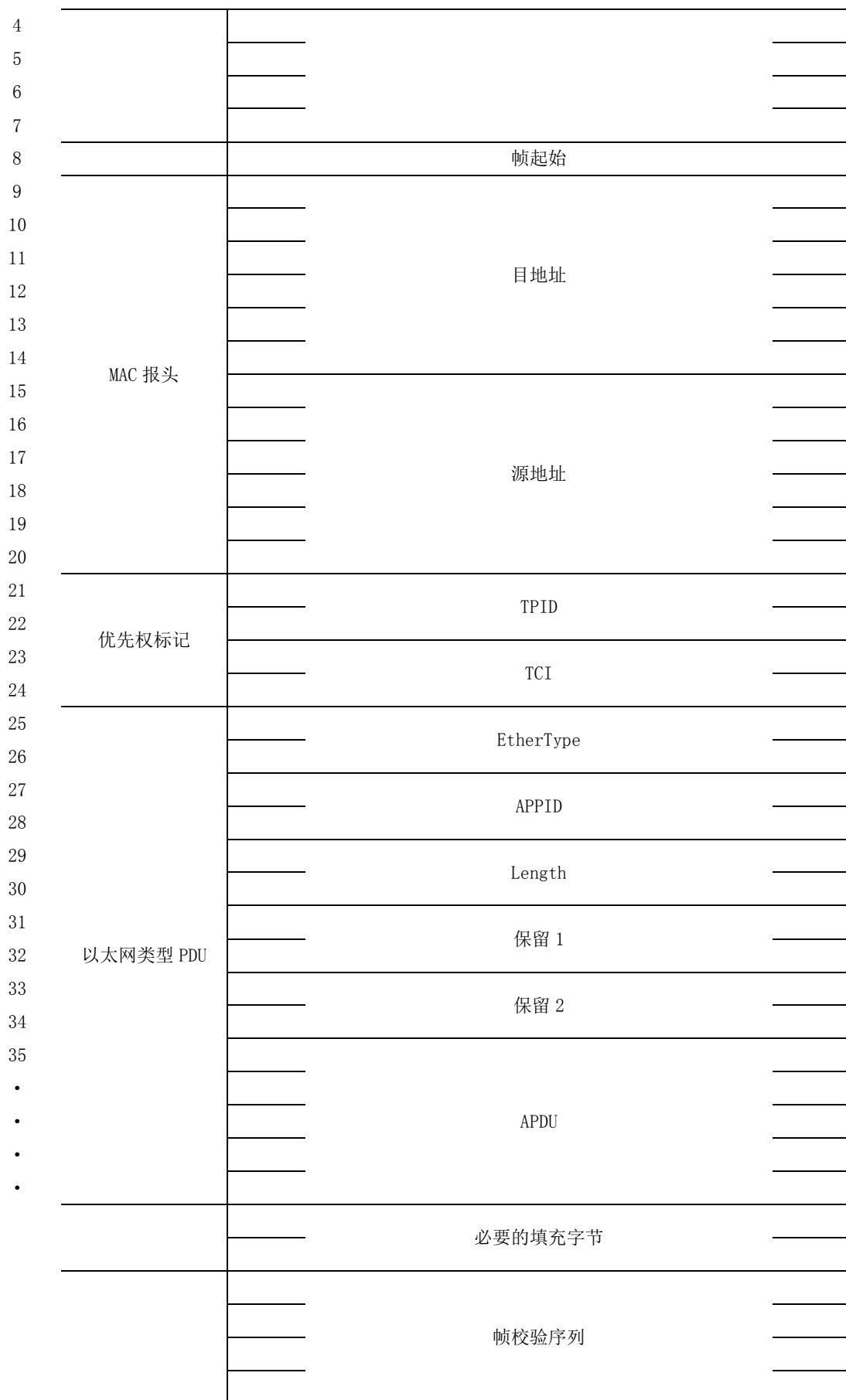
图 5 一以太网通信帧结构
